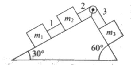
► **Solução** A figura abaixo mostra os blocos isolados com as forças que atuam sobre cada um. Devido à massa desprezível da corda e da polia, as tensões  $T_2$  e  $T_3$  são iguais. Vamos adotar o sentido positivo da aceleração aquele que corresponde à descida do corpo de massa  $m_3$ .
