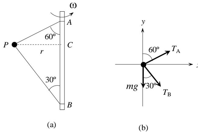
► **Solução** A figura (b) mostra as forças que atuam sobre a partícula de massa  $m$ . A direção  $x$  corresponde à direção que passa pelo centro do círculo descrito pela bolinha na situação indicada na figura. Para manter a bolinha em movimento circular, a resultante das forças deve estar nessa direção, com  $R_x$  fazendo o papel da força centrípeta. Assim
