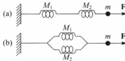
► **Solução** No caso (a), a condição de equilíbrio mostra que a força  $F$  é transmitida para ambas as molas produzindo diferentes deformações  $x_1 = \frac{F}{k_1}$  e  $x_2 = \frac{F}{k_2}$ . A deformação total das duas molas é  $x = x_1 + x_2$ . Se substituirmos esta mola por uma outra que tenha a constante  $k$ , tal que sob a ação da mesma força  $F$  ela sua deformação seja  $x$ , então
