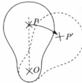
Rotação em torno de um ponto fixo.
